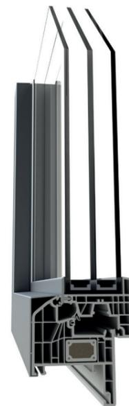
Fissaggio tra anta e vetro con speciale biadesivo e schiuma strutturale per un'ottima resistenza statica e funzionale del serramento.
